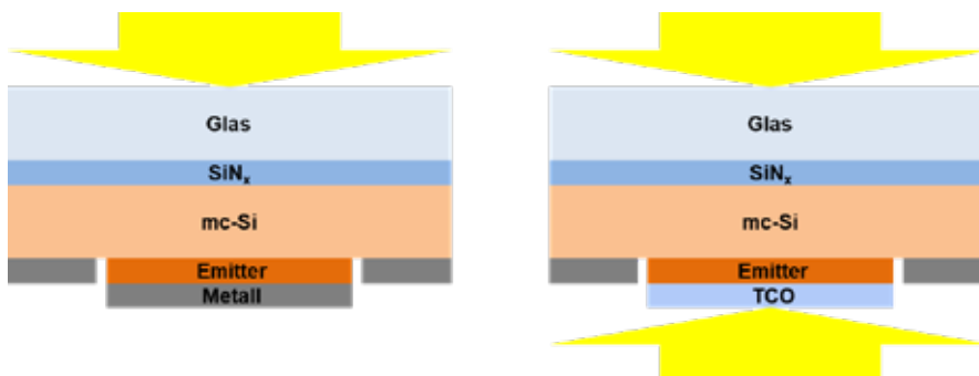
Abb. 1: Monofaciale (links) und bifaciale (rechts) Dünnschicht-Solarzellen aus laserkristallisiertem multikristallinem Silizium
